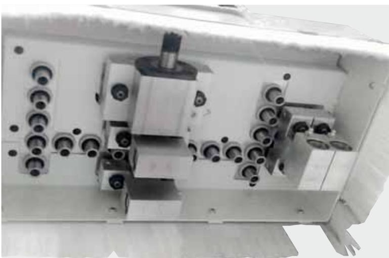
**Bohraggregate mit 18 Vertikal-
